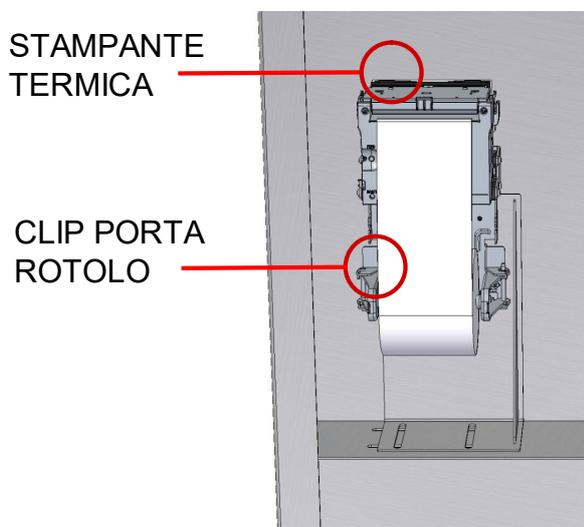
Per sostituire il rotolo di carta termica allargare le clips porta rotolo ed inserire il nuovo rotolo di carta. Successivamente inserire il lembo del rotolo nel beccuccio di stampa fino a quando il meccanismo della stampante si attiverà trascinando la carta all'interno del beccuccio.
