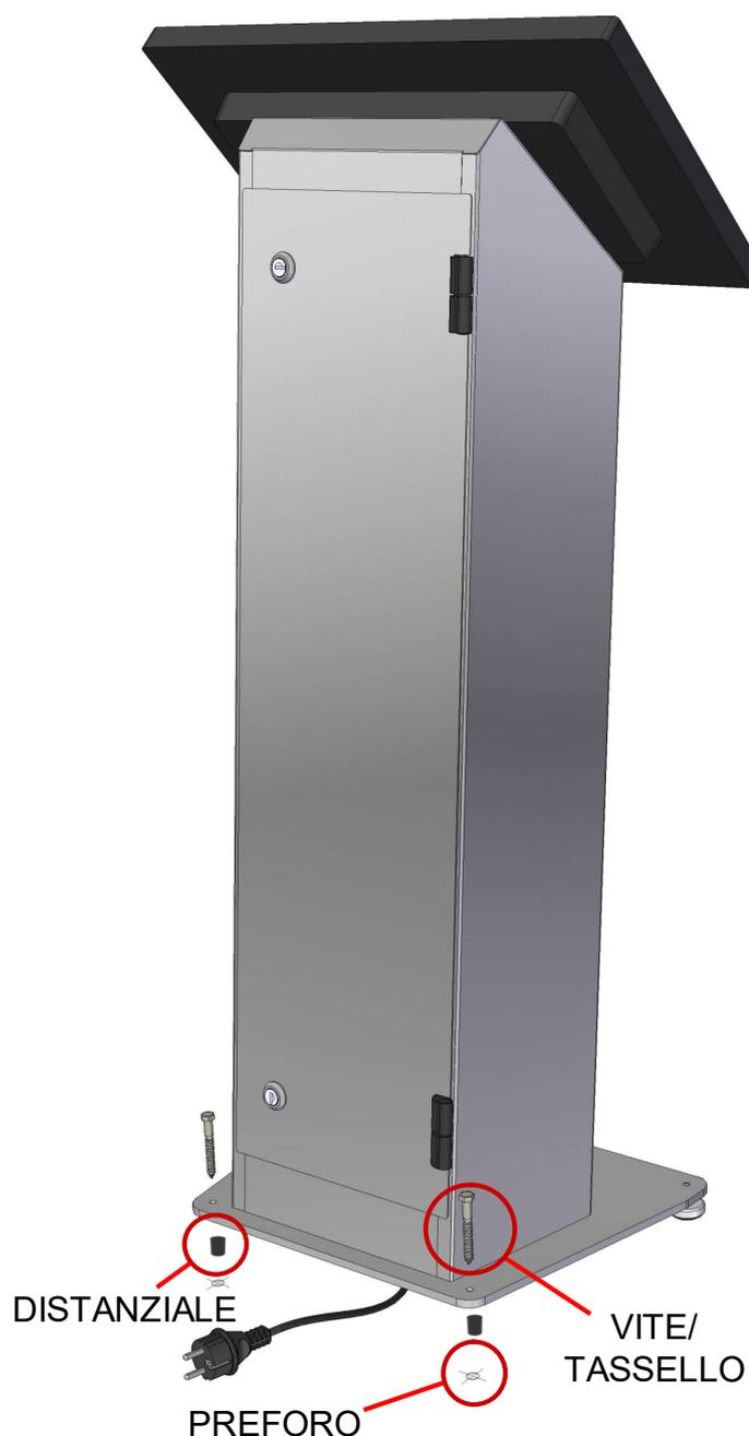
In locali aperti al pubblico, uffici, ambienti di produzione o in zone di intenso passaggio e per tutte le versioni del dispositivo provviste di mensola per tastiera prevedere un fissaggio che impedisca il ribaltamento del dispositivo per spinte o urti.
